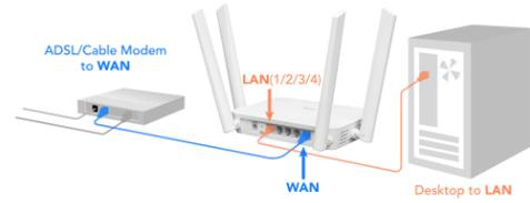
請參照以下示意圖，確保數據機、路由器與電腦的連線正確：
