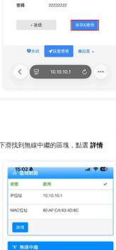
您可在此查看 **路由器與前端網路的連線方式及訊號強度** 等相關資訊，如訊號低於 **-70 dBm** 請移動路由至靠近前端機器的位置
