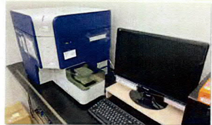
▲圖五：奈米粒徑 / 濃度 / 膜電位分析儀確保穩定外泌體精準純化粒徑品質
