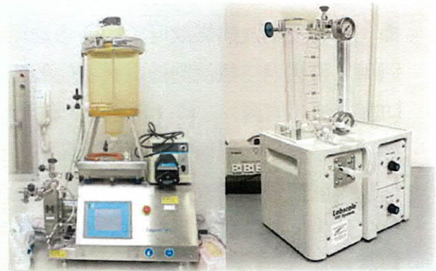
▲圖三：切向流濃縮過濾系統進行初步大量檢體濃縮
