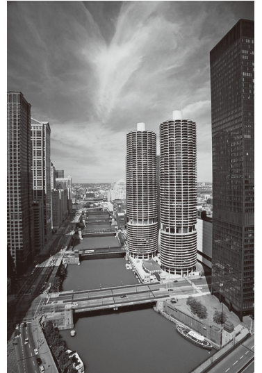
圖 13-30 一條緩慢流動的河流，具有幾乎是常數的深度與截面，例如這裡顯示的芝加哥河，是均勻流的一個例子，其 S_0 \approx S_f 及 dy/dx \approx 0 。 © Hisham F. Ibrahim/Getty RF
