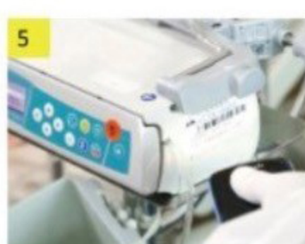
5 配對Pump及下載醫囑資料 (劑量、輸注時間、途徑)
