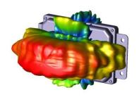
XFdtd 也經常用于各種雷達設計,如透地雷達,車 用雷達或各種不同用途的雷達,左圖爲一個除天綫 以外,亦包含外殼以及 PCB 等所有零件完整的汽車 雷達模型,汽車雷達經常在較高的工作頻率使用, FDTD 算法可以在模型的精度和硬件資源消耗之間 取得平衡。
