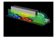
XFdtd 在 GPU 集群上模擬分析車對車近距離通信 以及大型車輛遮蔽信號的現象。
