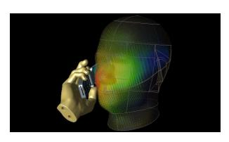
手機,平板,智慧型穿戴式裝置,醫療設備等產品由于會和人體密切接觸,需要確保安全無虞,因而會需要計算 SAR來瞭解電磁輻射對人體的影響,XFdtd支持不同標準的 SAR 計算,用戶可以配合標準的 CTIA 頭/手模型或是使用軟體自帶的高分辨率人體網格模型進行各種模擬。
