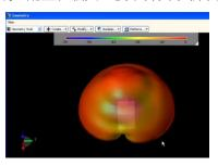
● 使用 XFdtd 設計人造衛星的螺旋天綫,並導出天綫輻 ● 射場型。
