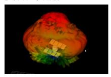
將螺旋天綫導入XGTD,配置在人造衛星上進行 模擬,求得受到載具影響的實際天綫場型。
